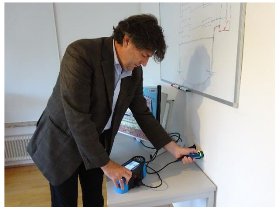
Messung an der elektrischen Hausanlage
